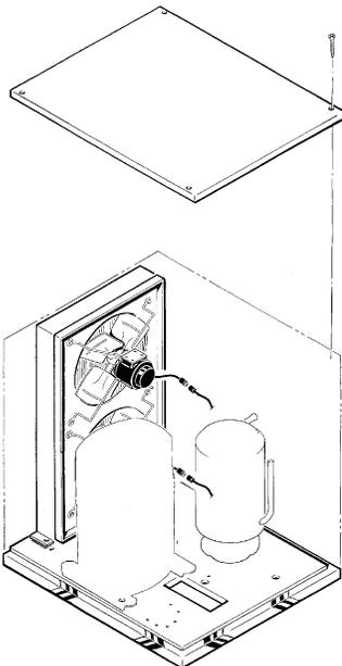
**3. PULL FAN MOTOR ASSEMBLY UP AND OUT**
