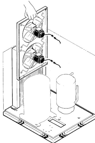
**2. REMOVE TWO SCREWS & UNPLUG FAN MOTORS.**
